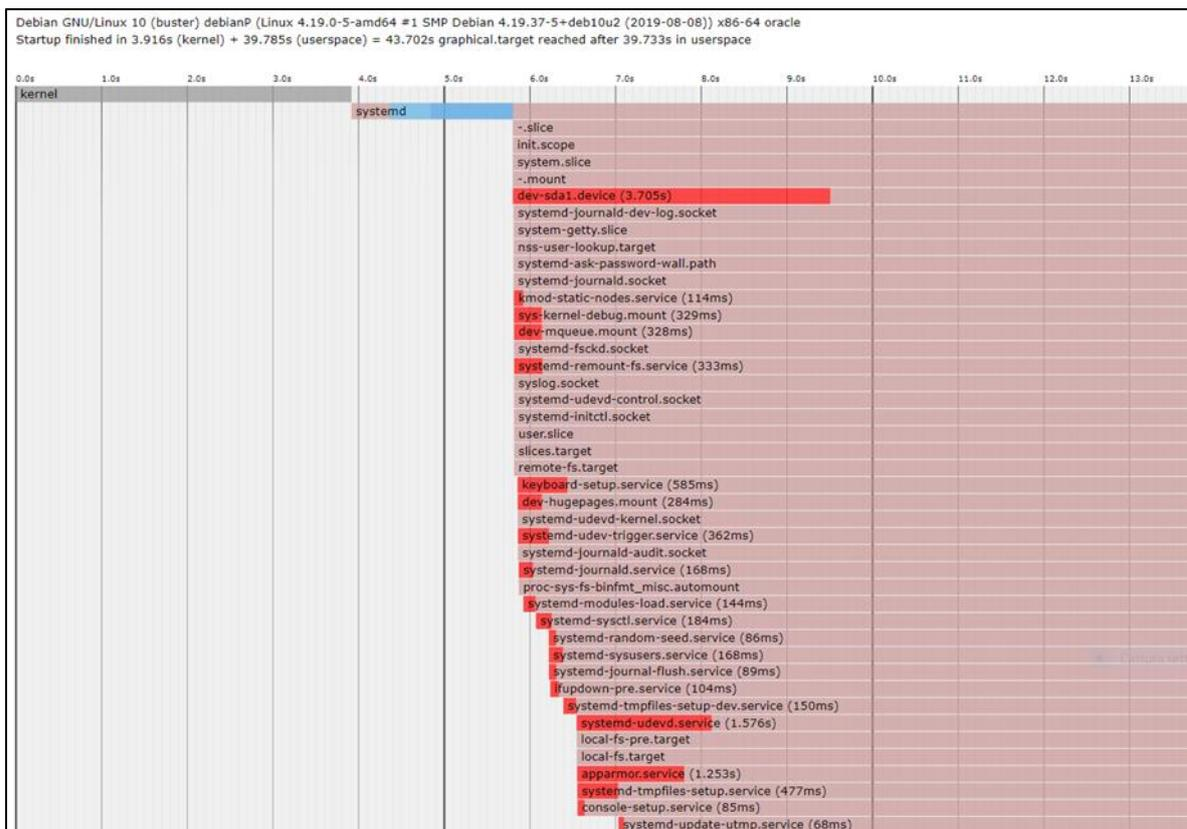
**Figura 4.7, File .svg generato dal comando "systemd-analyze plot"**
